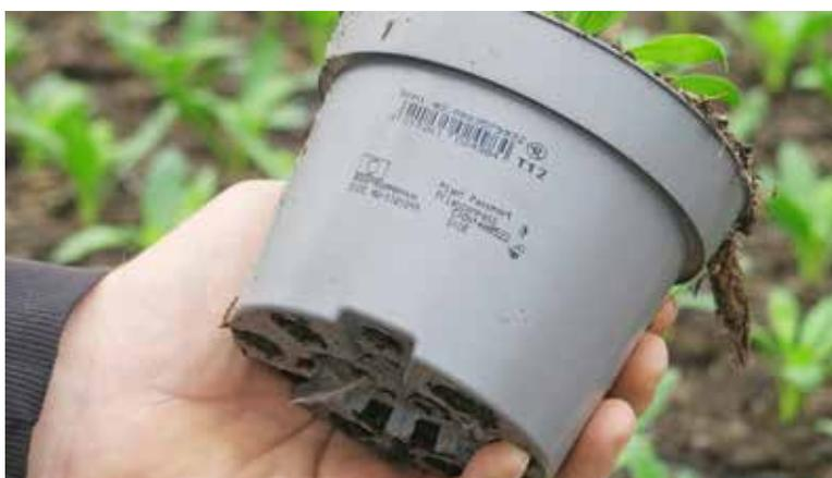
Der Druck erfolgt berührungsfrei, die Tinte wird nur punktuell aufgesprüht und ist sofort trocken.
