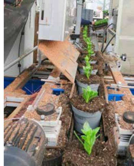
Um die Substratoberfläche mit einer Mulchschicht zu versehen, steht ein Abstreu-Automat zur Verfügung.
