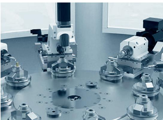
Drucken und Lesen in der Drehbewegung - die Lagenachführung ermittelt Position und Drehlage des Produkts.
