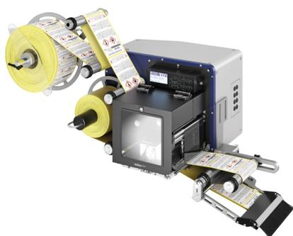
**4PL Swipe** kennzeichnet das Produkt in linearer Bewegung. Eine Bürste oder eine Rolle drückt das Etikett zusätzlich am Produkt an und ermöglicht so auch das Etikettieren auf Rundungen oder leichten Schrägen.
