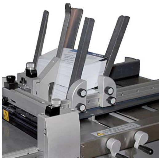
Magazynek wsadowy/skokowy umożliwia uporządkowanie przyjmowanych opakowań
