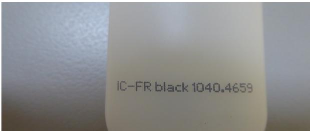
Seit Beginn der Pandemie ist die Nachfrage nach Desinfektionsmittel rasant angestiegen. Bereits seit 2020 kennzeichnet die Isopropanol-beständige Tinte mit einem Tintenstrahldrucker alphaJET die PE-Flaschen bei der Abfüllung von Desinfektionsmittel. Selbst wenn ein Tropfen des Isopropanol daneben geht verschmiert die Kennzeichnung nicht.
