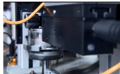
Bild (Quelle: Henn, AT): Kennzeichnung in der Produktionslinie. hier: Barcode auf eine Schlauchverbindung
