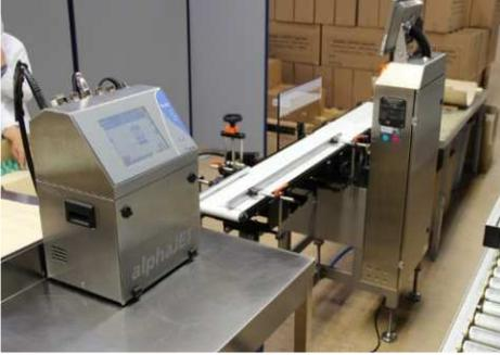
Die befüllten und versiegelten Kapseln werden in Pappschachteln konfektioniert. Über ein Transportband wird diese Verkaufspackung zunächst über eine Kontrollwaage, dann am Druckkopf vorbeibefördert. Hier beschriftet der Inkjet den Karton in einer dafür vorgesehenen Aussparung mit der dreizeiligen, variablen Produktinformation.
