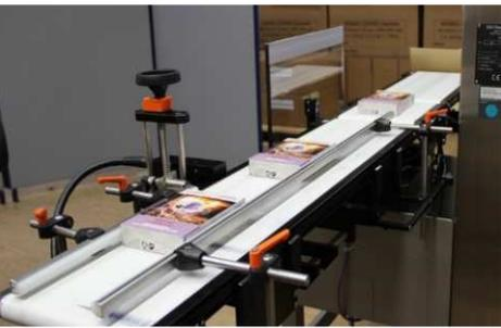
Passiert die Verkaufseinheit den Signalgeber, errechnet der alphaJET mondo selbständig die Entfernung bis zum Druckstart. Geschwindigkeitsschwankungen der Produktionslinie haben keinen Einfluss auf die passgenaue Kennzeichnung.
